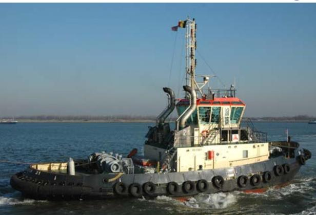
**Havensleepboot 21 (BE) – Remorqueur avec méthanol dans des moteurs de combustion**
