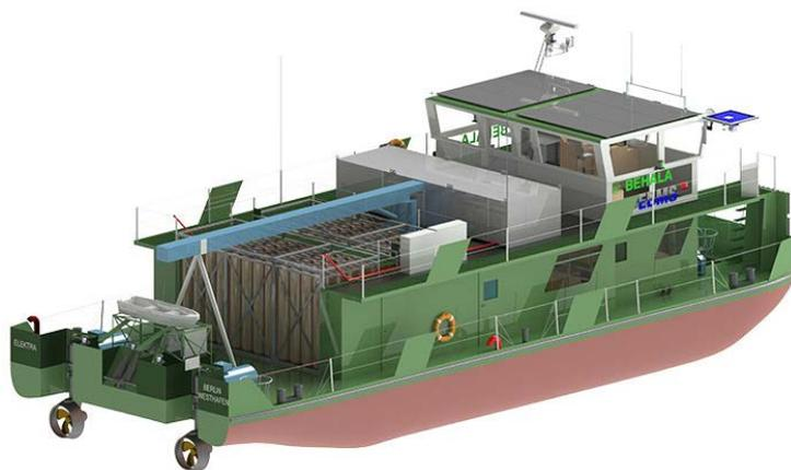
**ELEKTRA (DE) - Pousseur avec pile à combustible hydrogène – Mise en service printemps 2021**
