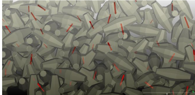
Figure 9 – Vectorisation du mouvement des blocs entre deux dates
