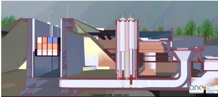
Figure 13 - Extrait de l'animation du passage d'un bateau dans une écluse
