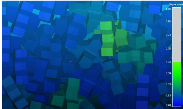
FIGURE 7 – VISUALISATION COLORISEE DU MOUVEMENT DE CHAQUE BLOC ENTRE DEUX LEVES ET VECTORISATION DU DEPLACEMENT
