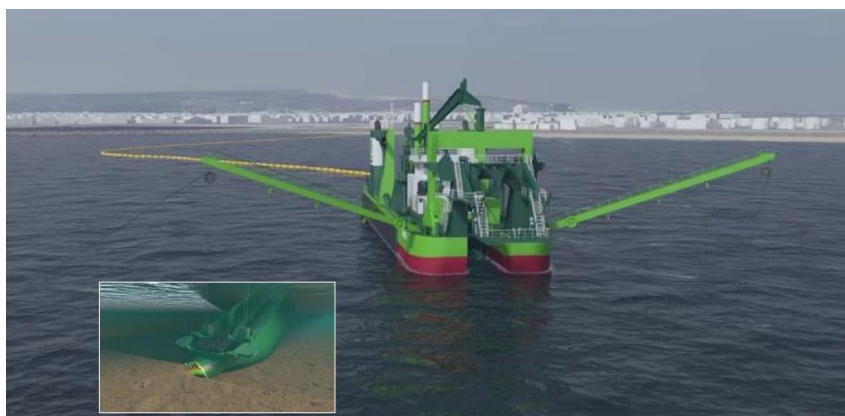
Figure 3 : Illustration du dragage à l'aide d'une drague stationnaire à désagrégateur
