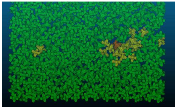
FIGURE 8 – VISUALISATION DU DEPLACEMENT DES BLOCS SUR MAQUETTE PHYSIQUE
